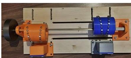
Wenn sich Rotor 1 (im Bild orange) dem Sticky Point nähert, soll Rotor 2 (blau) durch die versetzte Anbringung ausreichend Schwung erzeugen, um dem Rotor 1 über den Sticky Point hinwegzuhelfen, ebenso umgekehrt. Allerdings reichte diese Maßnahme nicht aus, um den gewünschten Effekt, das heisst einen kontinuierlichen Betrieb der Rotoren, zu ermöglichen.
