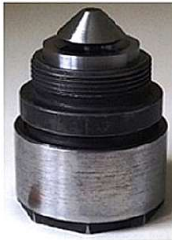
Рис.20. Конструктивная схема и внешний вид ударного клапана
